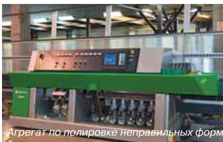
Комплекс обработки кромки стекла
